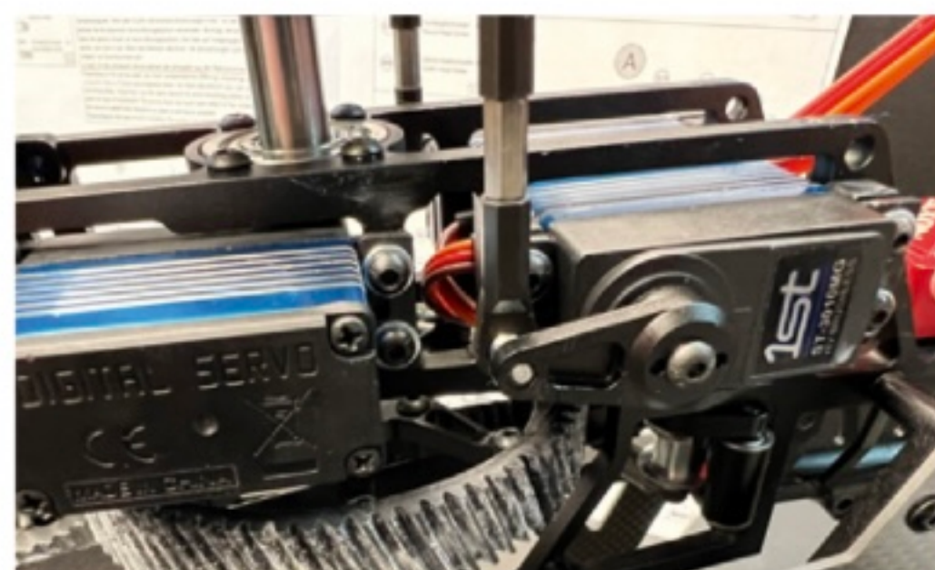
Kurze, direkte Anlenkungen der Taumelscheibe sorgen für kaum spürbares Spiel in der Rotorkopfmechanik
