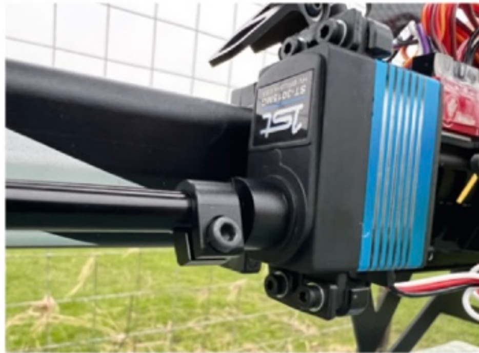
Eine Besonderheit des Strike 6.1 ist die Heckrotoranlenkung über einen Drehstab
