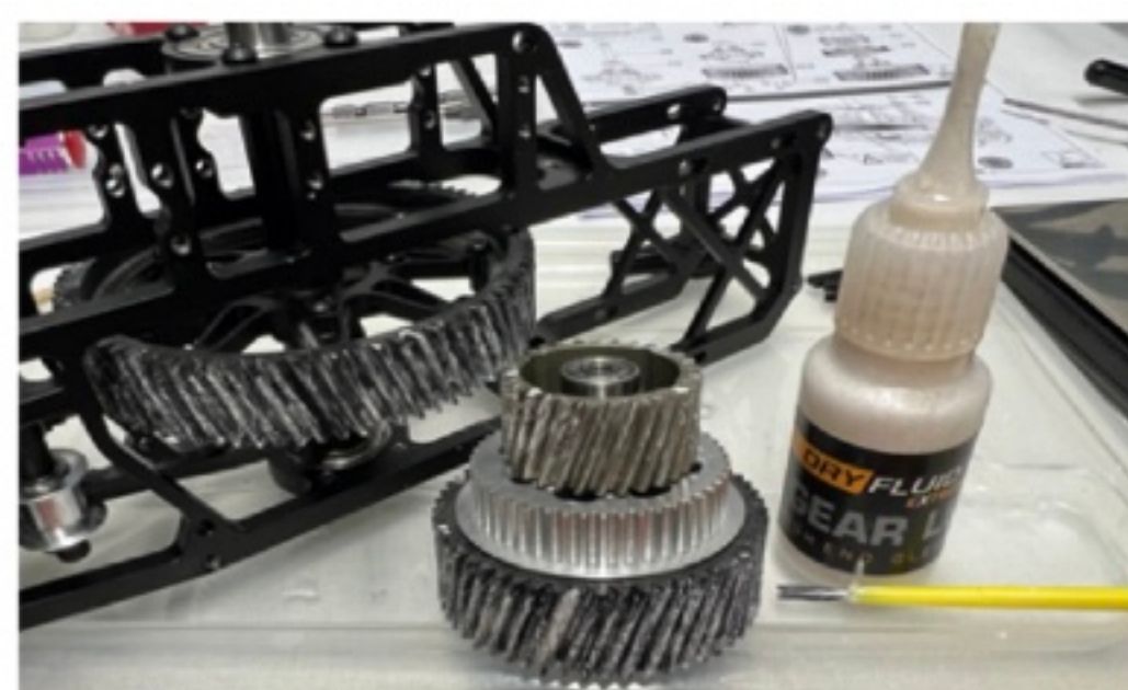
Das zweistufige Getriebe setzt auf eine Alu-Kunststoff-Materialpaarung. Der Freilauf ist im Zwischengelege integriert
