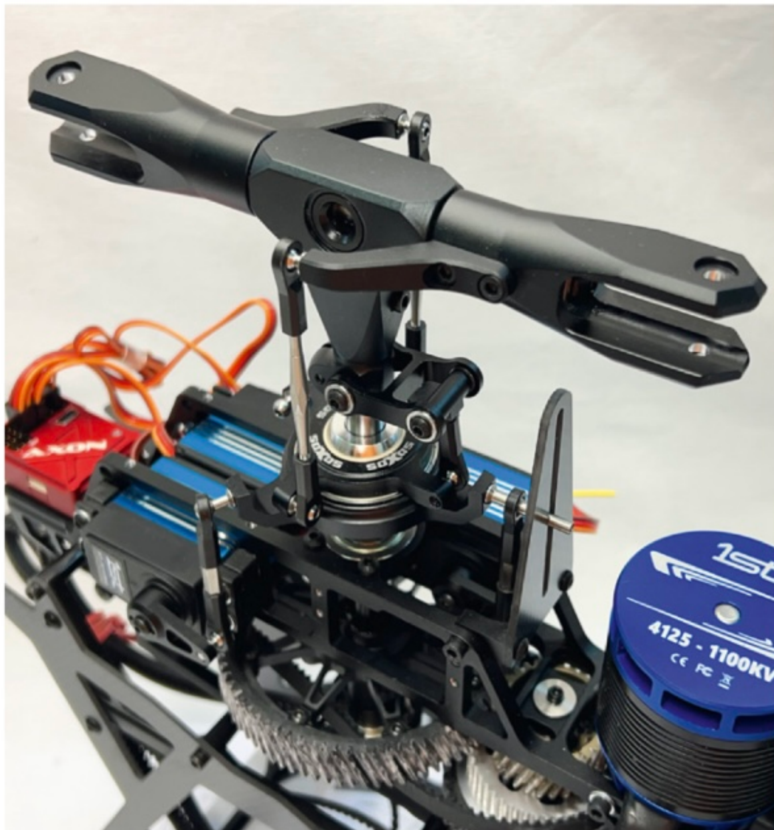
Das Aluminium-Ritzel des kräftigen Außenläufers verfügt über ein üppig dimensioniertes Gegenlager
