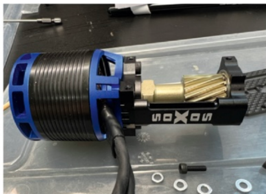
Das Aluminium-Ritzel des kräftigen Außenläufers verfügt über ein üppig dimensioniertes Gegenlager
