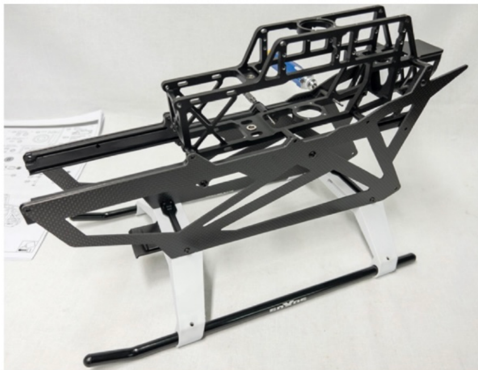
Der Unterteil des Helis besteht klassisch aus CFK-Platten und Kunststoffteilen
