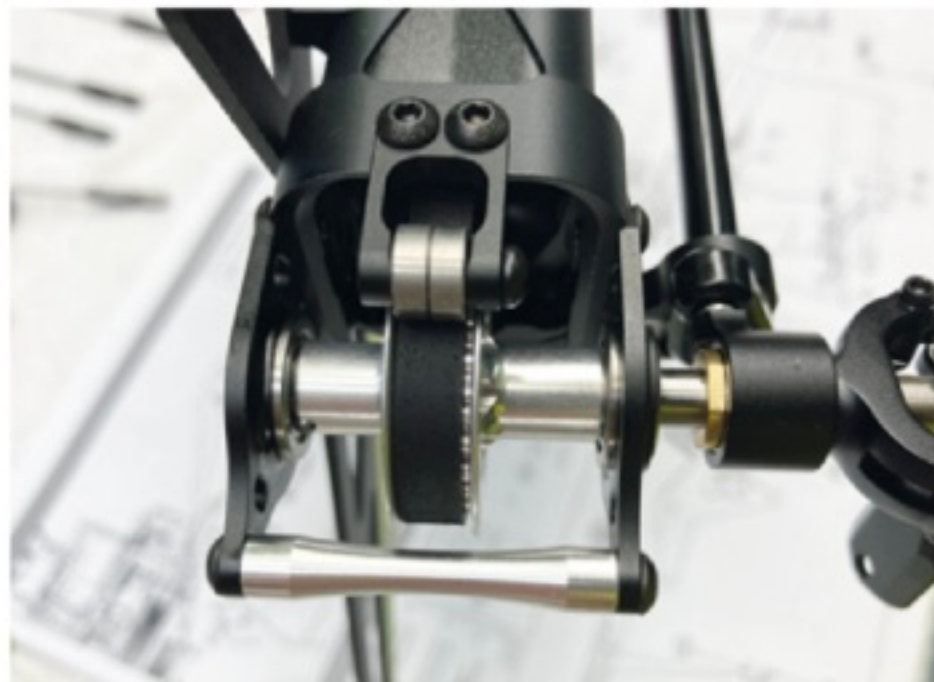
Das große Riemenrad am Heckrotor sorgt für eine optimale Kraftübertragung
