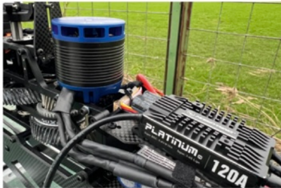
Ein 120-Ampere-Regler von Hobbywing treibt den Außenläufer an. Um eventuelle Spannungseinbrüche des BEC-Systems zu kompensieren, ist ein Puffer-Kondensator verbaut
