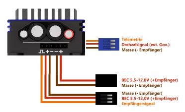
In der Regel werden die Signal- und BEC-Kabel im Heli von vorne nach hinten am Motor vorbei verlegt. Bitte beachten Sie dabei, dass die Empfänger-, Telemetrie- und BEC-Kabel gebündelt auf einer Seite entlang geführt werden müssen!
