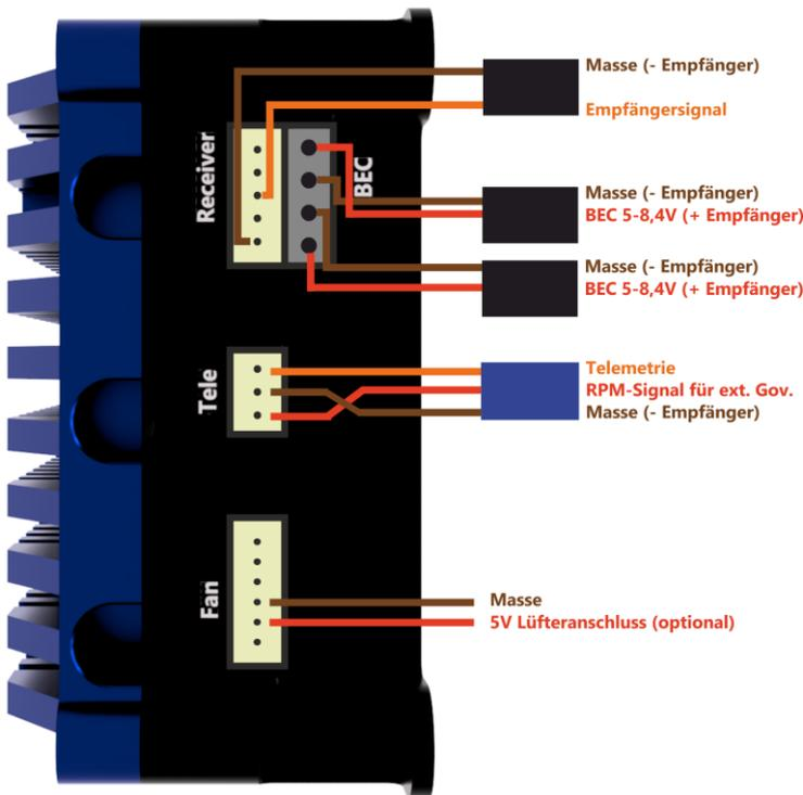
In der Regel werden die Signal- und BEC-Kabel im Heli von vorne nach hinten am Motor vorbei verlegt. Bitte beachten Sie dabei, dass die Empfänger-, Telemetrie- und BEC-Kabel gebündelt auf einer Seite entlang geführt werden müssen!
