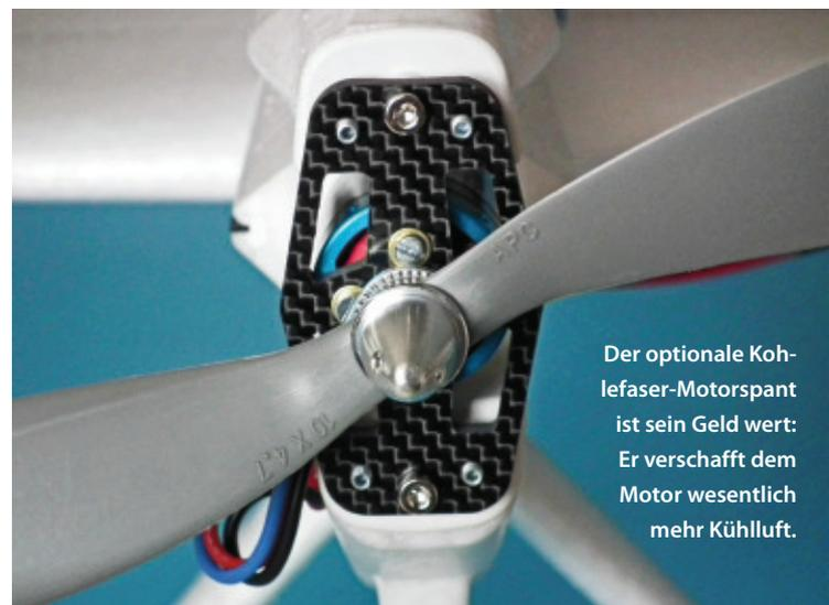
Der optionale Kohlefaser-Motorspant ist sein Geld wert: Er verschafft dem Motor wesentlich mehr Kühlluft.
