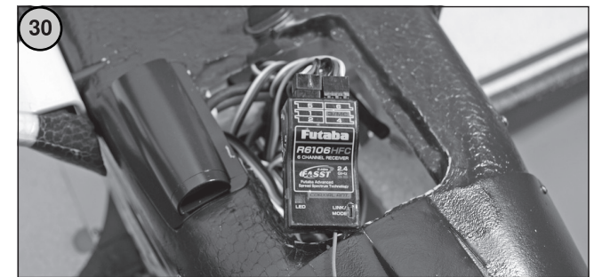
Bild 30 Bei den folgenden Arbeiten die Anleitung der Fernsteuerung beachten: - Durch Anschließen der Servos an die entsprechenden Kanäle des Empfängers die Steuerfunktionen zuordnen. - Regler anschließen. - Den Empfänger platzieren. - Die Litzenantenne(n) des Empfängers gemäß Anleitung des Fernsteuersystems verlegen. - Zwei Klettbandstreifen (Hakenband) zur Befestigung des Akkus in den Akkuschacht kleben.
