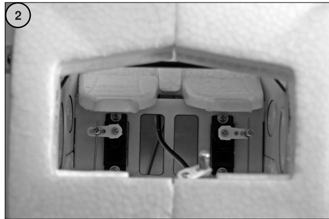
Bild 2 - Falls erforderlich, das Höhenrudergestänge an der Kupplung des Höhenruderservos lösen.
