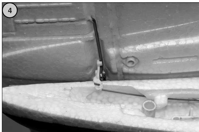
Bild 4 - Gestänge im Ruderhorn des Höhenruders einhängen. Höhenleitwerk auf das Rumpffende setzen.
