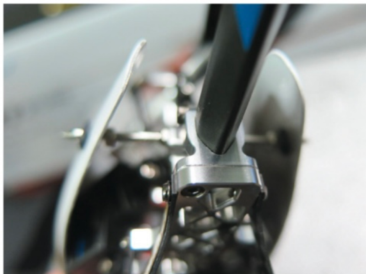
Das fünfeckige Heckrohr wird formschlüssig vom Chassis aufgenommen. Der Heli ist eine saubere Konstruktion aus gefrästen Aluminiumteilen und CFK-Komponenten
