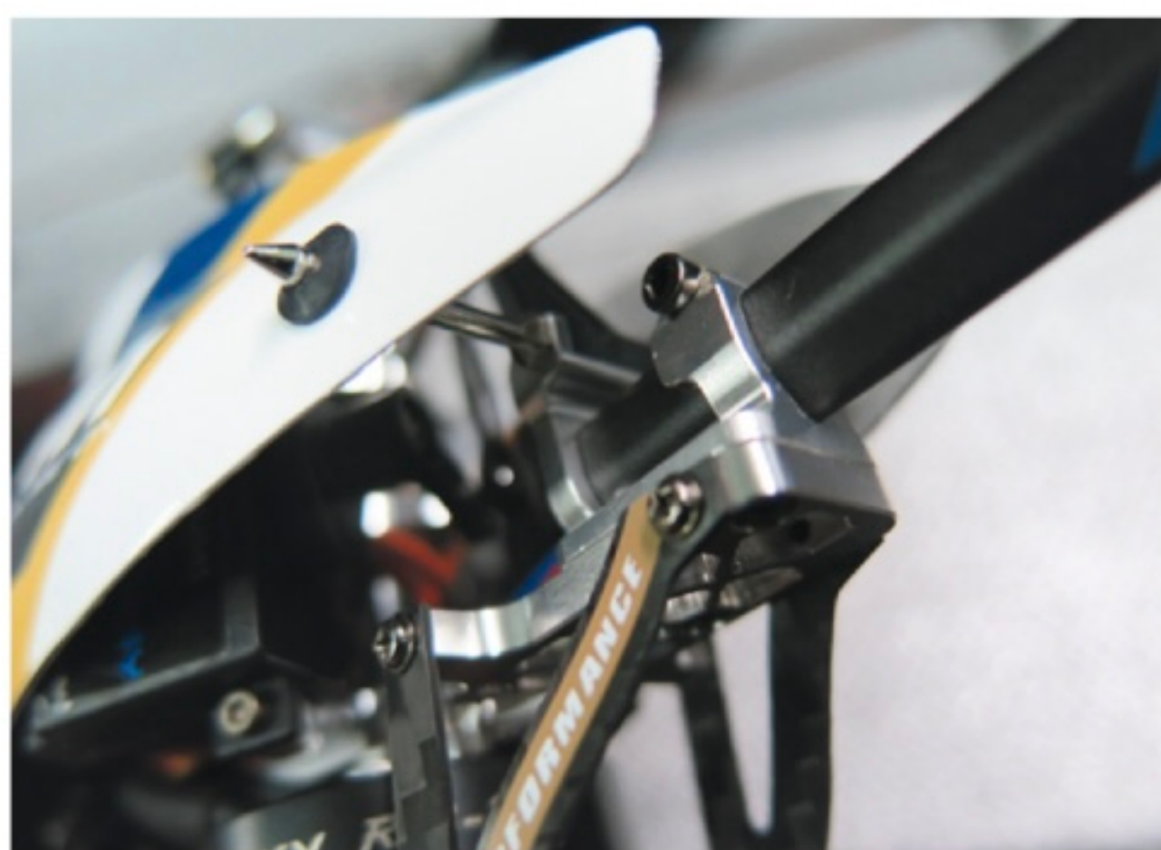
Die kleine GFK-Haube wird klassentypisch mit Gummitüllen am Chassis befestigt
