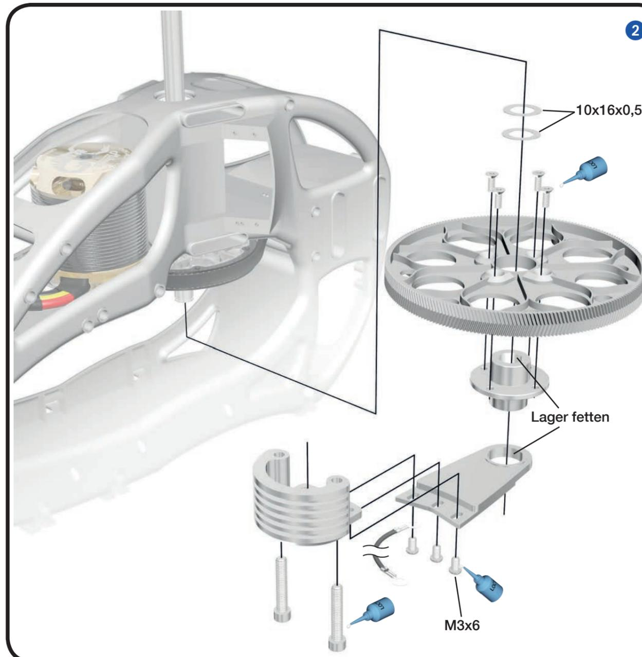
**Einbau und Befestigung Motorritzel**
