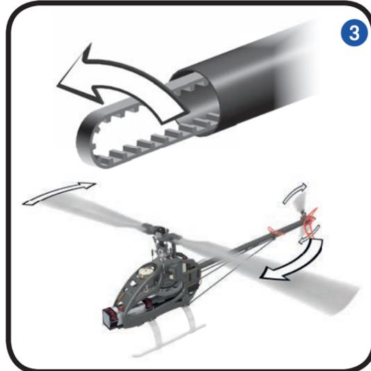
Heckrohr vorsichtig bis zum Anschlag einschieben, dabei die Aufnahme nicht beschädigen und die Schrauben endgültig festziehen.
