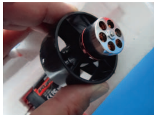
Zusammen mit dem 50-Millimeter-Fünfblatt-Impeller sorgt der hoch drehende Außenläufer für fulminanten Speed
