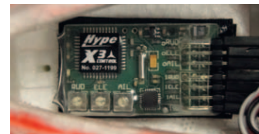
Eingebauter Flächenkreisler X3-Control – er sorgt für ein sehr stabiles Flugverhalten. 50 Prozent Expo sind dennoch nötig
