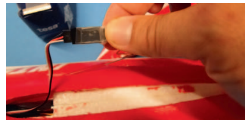
Die Steckverbindung zum Seitenruderservo unbedingt auf Zugbelastung sichern. Klebeband ist okay, Schrumpfschlauch optimal
