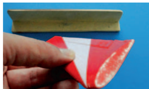
Wichtig: Vor dem Einkleben der Leitwerksteile den Lack an den Klebeflächen abschmirgeln, sonst hält es nicht dauerhaft
