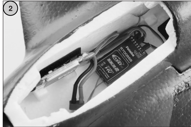
Bild 2 - Einbau der RC-Komponenten: Verbinden Sie den Drehzahlregler und die Steuerservos mit dem Empfänger. - Befestigen Sie den Regler und den Empfänger mit Klettband im Rumpf wie abgebildet.
