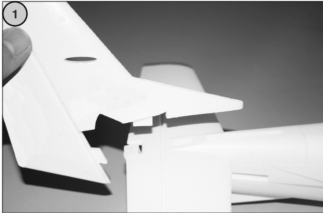
Bild 1 - Kleben Sie das Seitenleitwerk ein. Achten Sie auf eine exakte rechteckige Ausrichtung zum Höhenleitwerk (siehe Bild 2).
