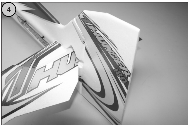
Bild 4 - Versetzen Sie dann die Aufnahmeschlitz im Seitenleitwerk mit etwas Kleber und stecken Sie das Seitenruder ein. Achten Sie hier unbedingt darauf, dass kein Klebstoff zwischen Seitenleitwerk und Seitenruder gelangt, um die Beweglichkeit nicht zu beeinträchtigen!
