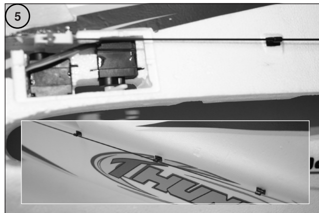
Bild 5 - Die Abbildung zeigt das in die Führungen eingesteckte Steuergestänge für das Seitenruder auf der rechten Rumpffseite. - Zur Montage des Seitenrudergestänges müssen Ruder und Leitwerk genau miteinander fluchten!
