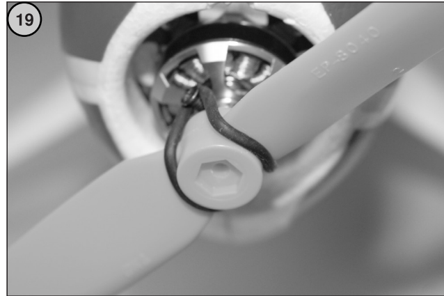
Bild 19 - Stecken Sie anschließend den Propeller auf die Motorwelle. Der Zentrierring zeigt dabei zum Motor. - Arretieren Sie dann den Propeller auf der Motorwelle mit einem Propellerbefestigungsgummi.
