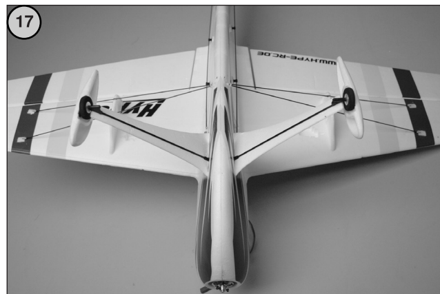
Bild 17 - Die Abbildung zeigt das fertig montierte Fahrwerk am Rumpf.
