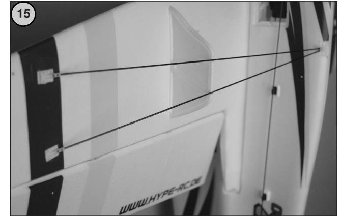
Bild 15 - Anschließend verkleben Sie links und rechts die Flächenstreben in die angeformten Vertiefungen an Rumpf und Fläche. Mit diesem Bauschritt sind die Montagearbeiten an Leitwerk und Fläche abgeschlossen.
