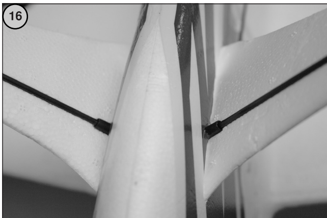
Bild 16 - Kleben Sie die Fahrwerksbeine in die Halterungen am Rumpf.
