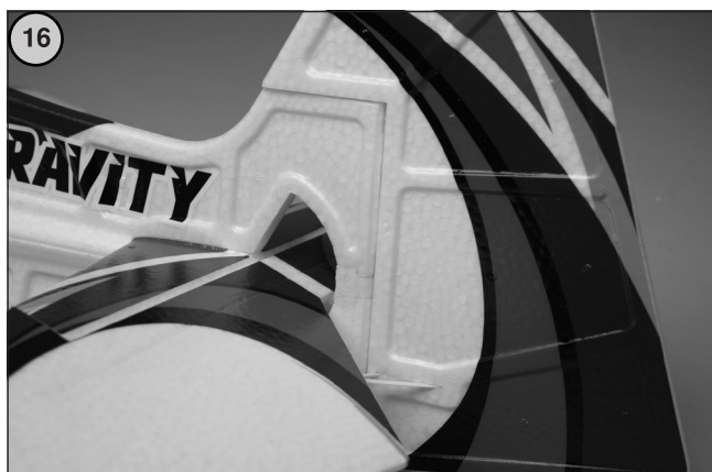
Bild 16 - Die Abbildung zeigt das fertig eingeklebte Seitenruder.
