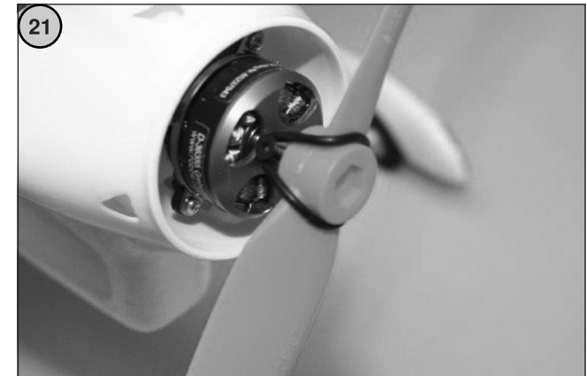
Bilder 21 bis 24 - Stecken Sie anschließend den Propeller auf die Motorwelle. Der Zentrierring zeigt dabei zum Motor. - Arretieren Sie dann den Propeller auf der Motorwelle mit einem Propellerbefestigungsgummi.
