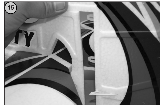
Bild 15 - Versehen Sie dann die Aufnahmeschlitz im Seitenleitwerk mit etwas Kleber und stecken Sie das Seitenruder ein. Achten Sie auch hier unbedingt darauf, dass kein Klebstoff in die Scharniere gelangt!
