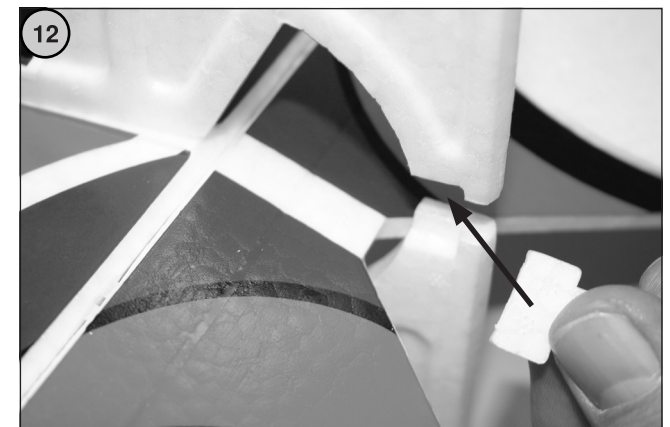
Bild 12 - Verkleben Sie das Höhenleitwerk mit dem Rumpf. Achten Sie darauf, dass kein Klebstoff in die Scharniere des Höhenruders läuft! - Kleben Sie das Füllstück in die Montageöffnung im Seitenleitwerk ein.
