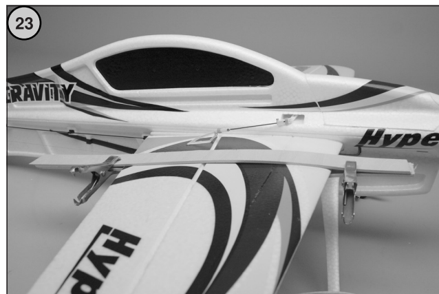
Bild 23 - Zur Montage der Querrudergestänge müssen Tragfläche und Querruder genau miteinander fluchten. Wir empfehlen Ihnen, dazu Ruder und Fläche mit zwei Holzleisten zu fixieren (siehe Abbildung).
