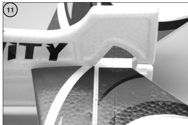
Bild 11 - Schieben Sie das Höhenleitwerk von hinten in den Aufnahmeschlitz am Rumpfeende. Richten Sie das Leitwerk genau rechtwinklig zur Rumpfhochachse aus. Achten Sie ebenso auf die parallele Ausrichtung des Höhenleitwerks zur Tragfläche.
