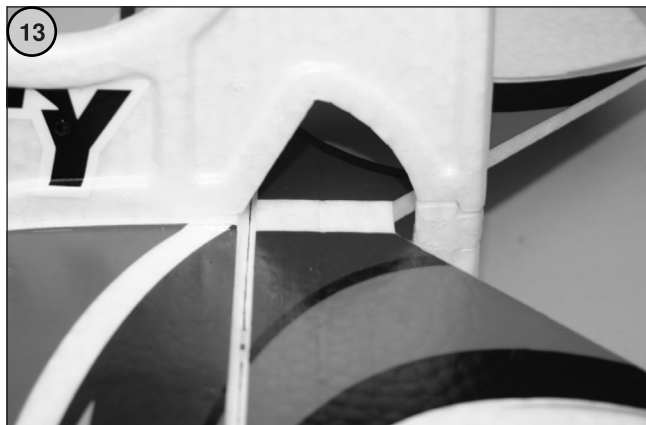
Bild 13 - Die Abbildung zeigt das fertig montierte Höhenleitwerk und das mit dem Füllstück geschlossene Seitenleitwerk..
