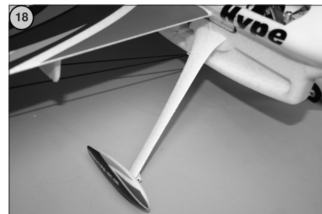
Bild 18 - Kleben Sie die Fahrwerksbeine in die Halterungen am Rumpf.
