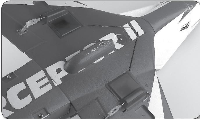
Setzen Sie den hinteren Deckel von unten auf den Rumpf und befestigen Sie ihn mit zwei Schrauben, wie dargestellt. / Put the hatch on the lower side to the fuselage and fix it with two screws, as shown. / Fissare il coperchio posteriore da di sotto sulla fusoliera e fermarlo con due viti, come mostrato in foto.
