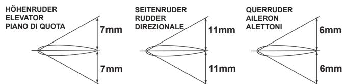
Die Werte werden an der Hinterkante der Ruder gemessen. Geben Sie auf beide Funktionen 40% Exponential-Anteil. / The values are measured at the rear edge of the flap. Set 40% Exponential on both functions. / si misura al bordo posteriore delle parti mobili. Date 40 % di esponenziale su entrambi funzioni.
