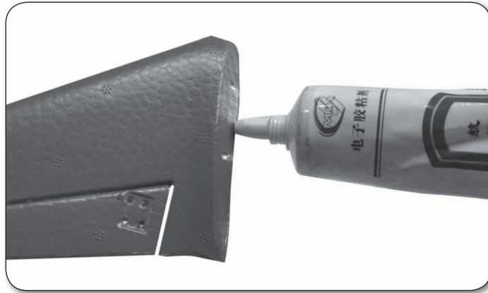
Setzen Sie das Höhenleitwerk an den Rumpf. Richten Sie das Leitwerk so aus, dass es leicht nach unten zeigt (negative V-Form). / Put the horizontal stab on the fuselage. Align the horizontal stab slightly downwards (negative V-shape). / Montare il piano di quota sulla fusoliera, deve mostrare leggermente in giù (a forma di V negativo).
