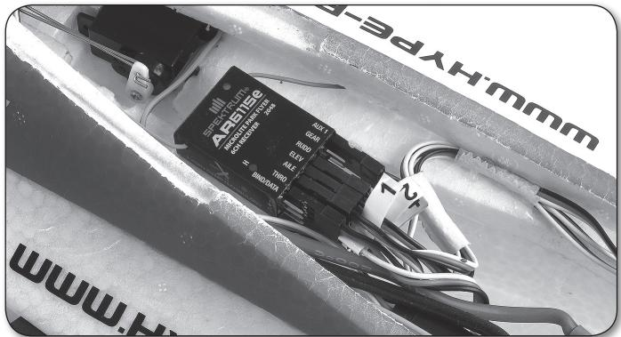
Setzen Sie nun den Antriebsakkumulator (3s LiPo 11,1V / 1.600mAh) in das Akkufach ein. Akku jetzt noch nicht am Regler anschließen! / Install the battery (3s LiPo 11,1V / 1.600mAh) in the lower front area of the fuselage. Do not connect the battery with the speed controller now! / Ora inserire la batteria (3s LiPo 11,1V / 1.600mAh) nella parte anteriore della fusoliera, ma non collegarla ancora con il regolatore!
