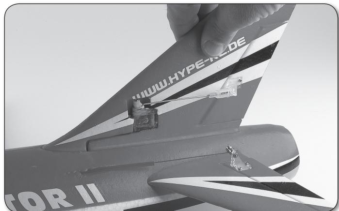
Lassen Sie den Klebstoff 12 Stunden aushärten, bevor Sie am Rumpf weiterarbeiten. / The glue needs 12 hours to harden before you can go on with the assembly on these parts. / Fare indurire per 12 ore la colla prima di continuare!
