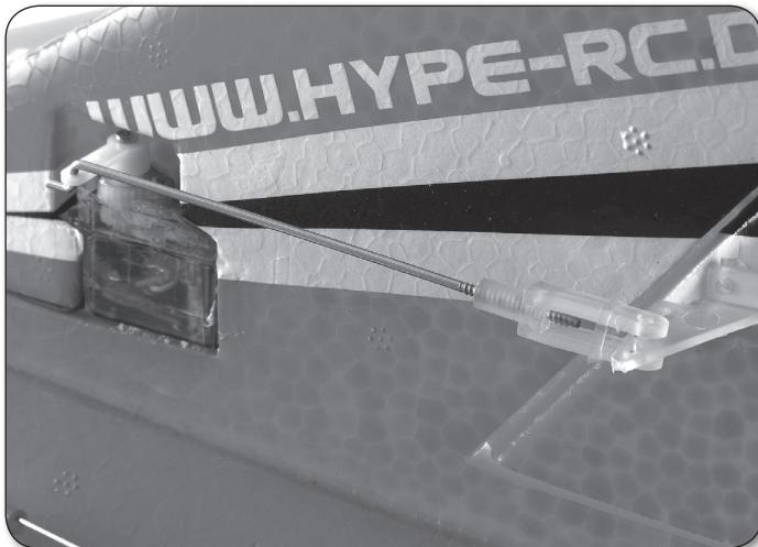
Montieren Sie die Ruderhörner an den Höhenrudern, verwenden Sie zwei Schrauben, die sich diagonal gegenüber liegen. Auf der Unterseite müssen die Schrauben in die entsprechenden Kunststoffplättchen greifen. / Install the elevator horns on both sides by using two screws in diagonal direction. The screws have to grasp into the plastic plate on the lower side of the elevator. / Montare le squadrette ai piani di quota, usando due viti in direzionale diagonale.
