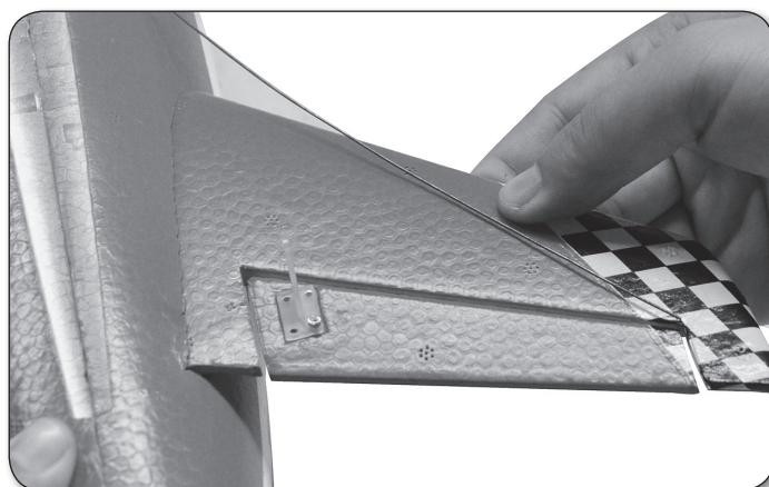
Wiederholen Sie den Vorgang für die linke Seite entsprechend. Abschließend beide Leitwerke gleichmäßig ausrichten. / Install the left horizontal stab in the same way. At the end check carefully, if both horizontal stabs are aligned in the same way! / Procedere analogamente per il lato sinistro. Poi allineare i due piani.
