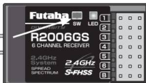
Durch Drücken der Taste „SW“ wird im Empfänger automatisch die individuelle Codenummer des Senders (130 Millionen Codes) gespeichert. Durch diese „Bindung“ reagiert der Empfänger nur noch auf die Signale des angebondenen Senders.
