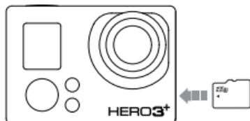
1. Stecken Sie die Speicherkarte mit dem Etikett zur Vorderseite der Kamera hin in den Kartensteckplatz.
