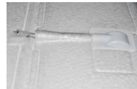
Die Abdeckung der Querruderservos – komplett verdeckt und damit unempfindlich.
