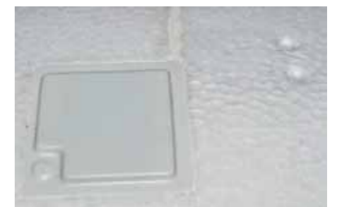
Auch die Störklappenservos sind sehr sauber abgedeckt. Die beiden Vertiefungen markieren den Schwerpunktbereich.
