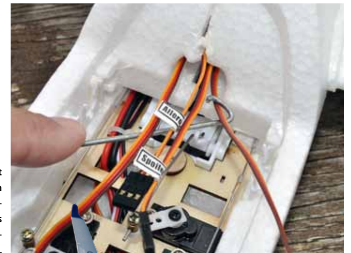
Montagetipp: Mit einem solchen Haken lassen sich die Flächenkabel prima in das Cockpit zum Empfänger ziehen.
