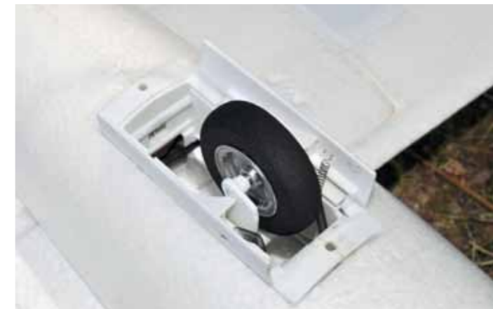
Der Arcus E 2.2 hat sogar ein Einziehfahrwerk, das tadellos funktioniert.
