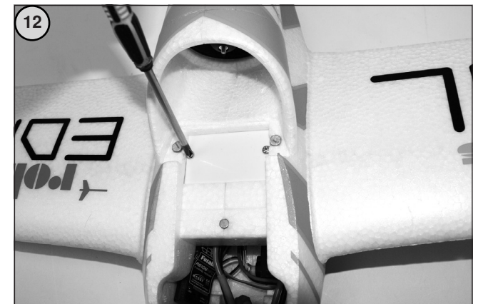
Bild 12 - Setzen Sie die Tragflächenverbindungsplatte ein und befestigen Sie diese mit den beiliegenden Schrauben im Rumpf.
