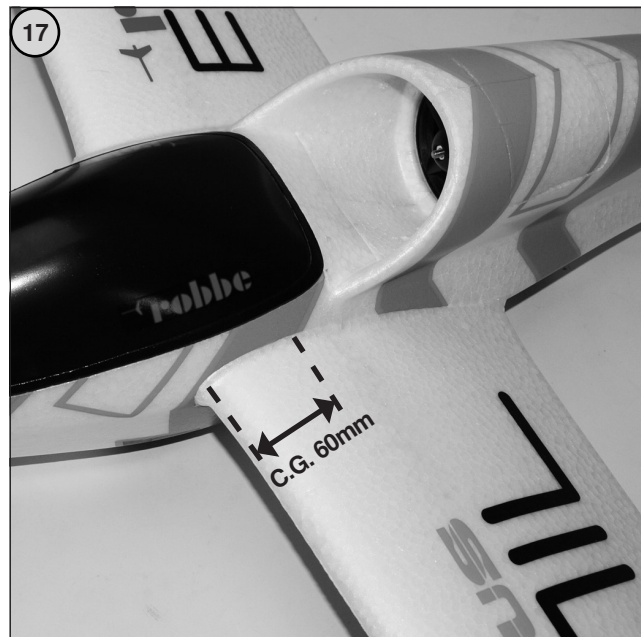
Bild 17 - Der Schwerpunkt "C.G." liegt bei dem Modell ca. 60mm (von der Nasenleiste gemessen). - Den Akku zum Auswiegen einlegen, nicht anschließen. - Den Schwerpunkt beidseitig auf dem Rumpf anzeichnen. - Das Modell im Schwerpunkt C.G. unterstützen und auspendeln lassen. Die Idealstellung ist erreicht, wenn das Modell mit leicht nach unten hängendem Vorderteil in der Waage bleibt. - Flugakku, falls erforderlich entsprechend versetzen. - Die Akkuposition im Rumpf anzeichnen, damit der Akku bei einem Wechsel wieder in der gleichen Lage eingebaut werden kann. - Den Akku in der gefundenen Position zusätzlich mit Klettband fixieren, damit er während des Fluges nicht verrutschen und die Schwerpunktposition verändern kann. - Das Modell ist nach erneutem Laden des Akkus startbereit.
