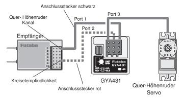
Falls die Empfindlichkeit über den Sender eingestellt werden soll, muss das rote Anschlusskabel an Port 2 angeschlossen werden.
