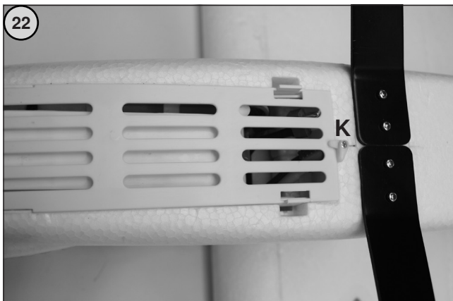
Bild 22 - Verschliessen Sie den Akkuschacht und sichern Sie die Abdeckung mit dem Sperrriegel „K“.
