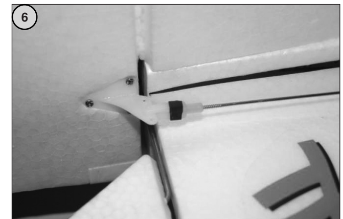
Bild 6 - Montieren Sie das Ruderhorn des Seitenruders mit der Gegenplatte auf der rechten Seite des Seitenruders. Hängen Sie das Anlenkgestänge mit dem Gabelkopf in das Ruderhorn ein und fixieren Sie die Verbindung mit dem Sicherungsring (siehe Abbildung).
