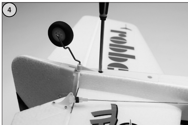
Bild 4 - Verschrauben Sie die komplette Leitwerkseinheit mit dem Rumpf wie abgebildet. - Montieren Sie das Ruderhorn für das Höhenruder mit der Gegenplatte von unten mit dem Höhenruder.
