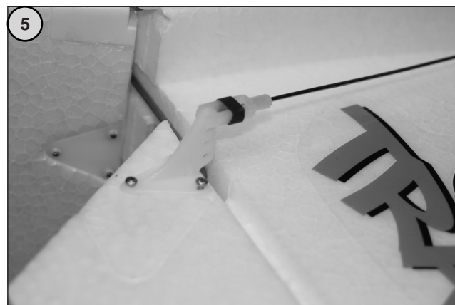
Bild 5 - Hängen Sie das Anlenkgestänge mit dem Gabelkopf in das Ruderhorn ein und fixieren Sie die Verbindung mit dem Sicherungsring (siehe Abbildung).
