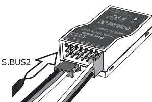
Stecken Sie den Temperatursensor an den S.BUS2-Ausgang Ihres Telemetrie-Empfängers, entweder direkt oder über ein V- bzw. HUB-Kabel. Der Sensor besitzt 2 durchgeschleifte Anschlüsse, so dass am freien Ausgang ein weiteres S.BUS2-Gerät oder Sensor angeschlossen werden kann.
