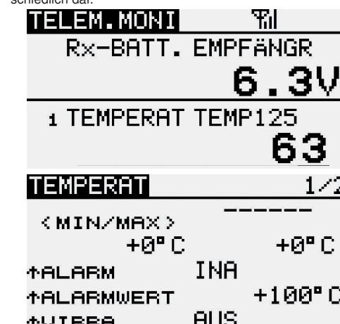
Displaydarstellung des Telemetrie Monitor und Sensormenüs im Sender FX-32.
