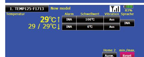
Displaydarstellung des Telemetrie Monitor und Sensormenüs im Sender T18MZ.
