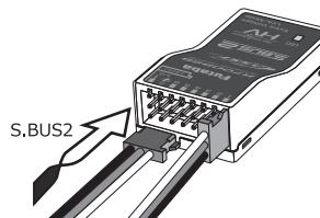
Plantez le thermocapteur dans la sortie S.BUS2 de votre récepteur télémétrique, soit directement soit via un cordon Y ou un cordon de bifurcation. Le capteur dispose
