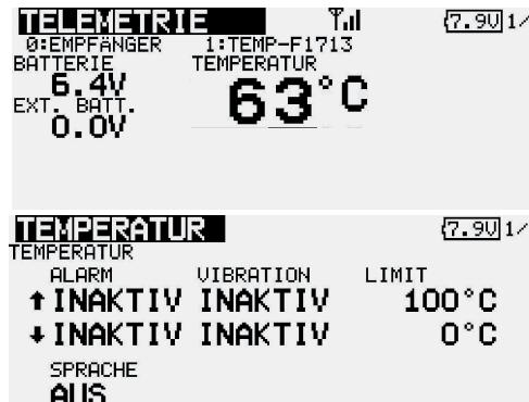
Displaydarstellung des Telemetrie Monitor und Sensormenüs im Sender FX-32.
