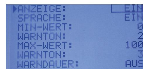
Displaydarstellung des Telemetrie Monitor und Sensormenüs im Sender T18MZ.
