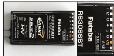
Der Empfänger R6308SBT be- sitzt verschiedene Ausgänge zum Anschluss unterschiedli- cher Servotypen, S.BUS-Ge- räten sowie Telemetrie-Sen- soren.
