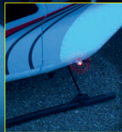
Auch wenn dies auf den Fotos nicht so recht den Anschein hat: Die farbigen LEDs haben eine hohe Leuchtkraft und tragen bereits bei leichter Dämmerung hervorragend zu einer verbesserten Sichtbarkeit des Modells bei!
