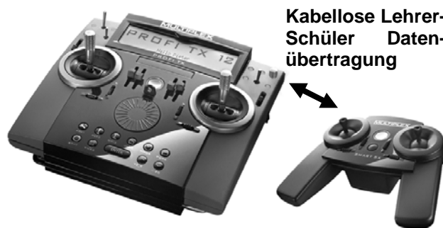
Lehrer-Schüler Betrieb in Verbindung mit einer PROFI TX von MULTIPLEX, mit Lehrer-Schüler Modul.
