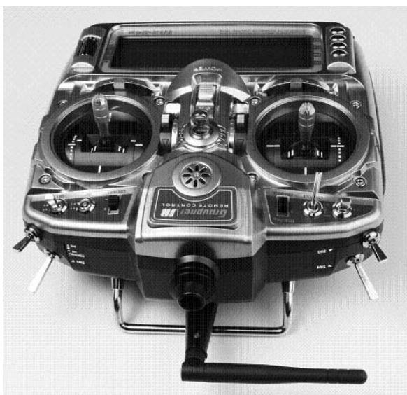
Bei Anwendungen, bei denen das Modell nicht direkt über dem Sender oder nicht direkt unter dem Sender betrieben wird (insbesondere bei Autos und Schiffen), ist eine Antennenstellung senkrecht nach oben optimal:
