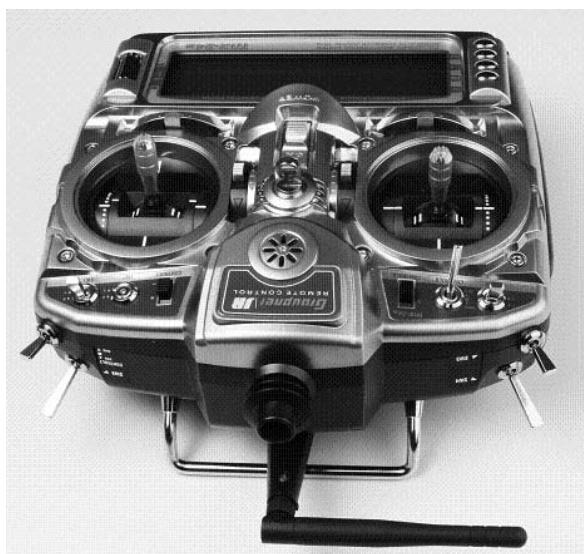
En usos en los que el modelo no se maneje directamente por encima de la emisora, o por debajo de esta (especialmente con coches o barcos), la colocación de la antena hacia arriba en vertical será la óptima:
