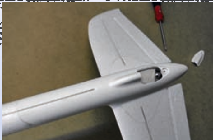
In die Balastkammer im Heck können mitgelieferte 9-g-Kügelchen zum Auswiegen des Schwerpunkts gelegt werden
