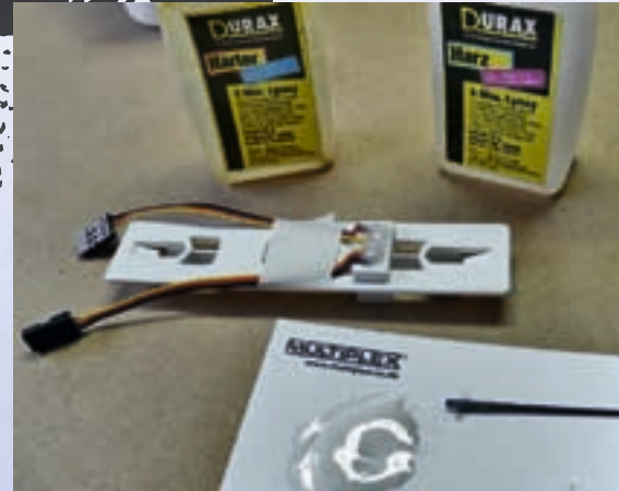
Die Kabel am Servostecker werden mit reichlich Kleber gegen Ausreißen gesichert – und dass sie nicht den LiPo beim Einschieben in den Akkuschacht beschädigen
