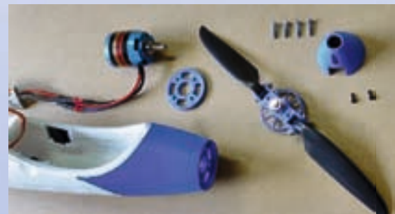
Gut 4 Minuten Motorlaufzeit sind mit dem Außenläufer Himax C 3516 – 1350 in Kombination mit einem 3S LiPo 2500 mAh und der 9x6-Klappflugschraube drin
