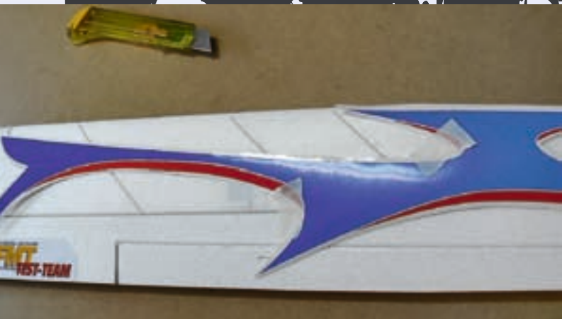
Um das Dekor passend aufzubringen, wird es mit Klebestreifen positioniert
