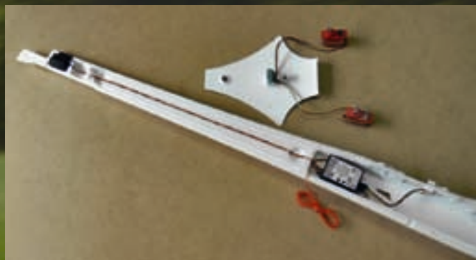
Sowohl das Verlängerungskabel fürs HR-Servo sowie die Steckverbindung für die QR-Servos sind zu löten
