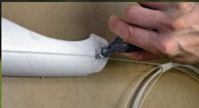
GFK-Verstärkung in Kanal einlegen und abzwicken – schon hat man die exakte Länge
