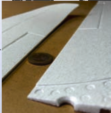
Multiplex hat die Elapor-Kügelchen so eng geschäumt, dass sehr dünne, aber stabile Flächen entstehen
