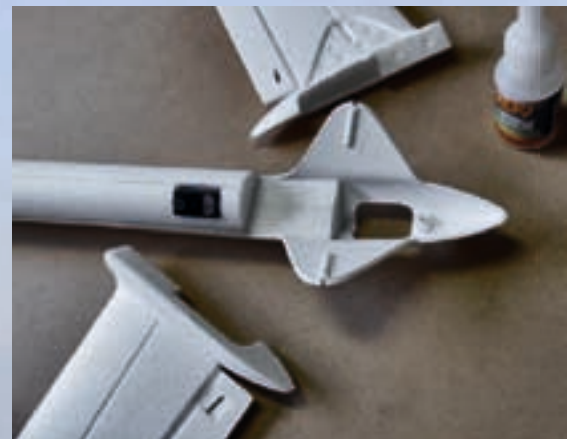
Beide V-Leitwerkshälften werden über ein Plastikformteil passgenau am Rumpf verklebt
