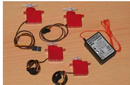
Der Empfänger RX-7-SYNTH IPD von Multiplex sorgt für den sicheren Empfang. Die Nano-S und Nano-Pro Karbonite Servos, ebenfalls von Multiplex, sind werksseitig schon mit langen Kabeln versehen
