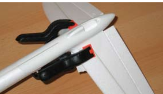
Beim Verkleben der Leitwerksteile sind Klemmen hilfreich
