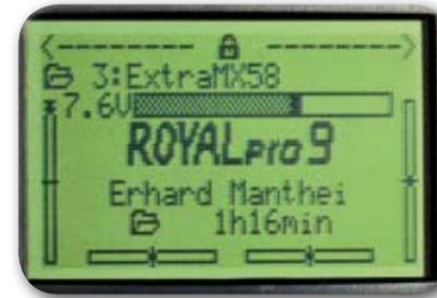
Screen der Statusanzeige nach dem Einschalten. Bei geöffnetem Schloss können diverse Einstellparameter auf die 3D-Digi-Einsteller aufgeschaltet und im Flug angepasst werden. Das aktuelle Modell war schon eine Stunde und 16 Minuten in Betrieb, die Senderakkuspannung beträgt 7,6 Volt
