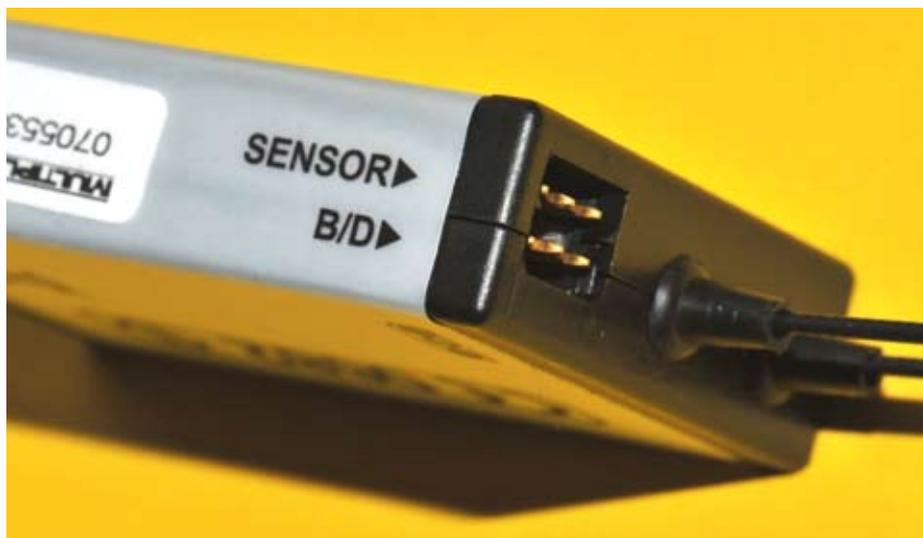
**An der Stirnseite werden künftig alle Sensor-Module angeschlossen, ebenso bei Bedarf ein zweiter Doppelpempfänger**
