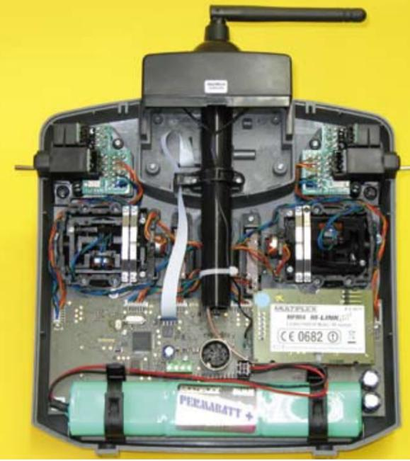
Blick in das geöffnete Sendergehäuse. Der 2,4-Gigahertz-Baustein ist bereits eingesetzt, die Sendeantenne durchgeschoben und abgewinkelt
