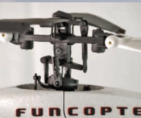
Der Rotorkopf des FunCopter ist vom LMH bekannt, er ist mitverantwortlich für das einsteigerfreundliche Flugverhalten.
