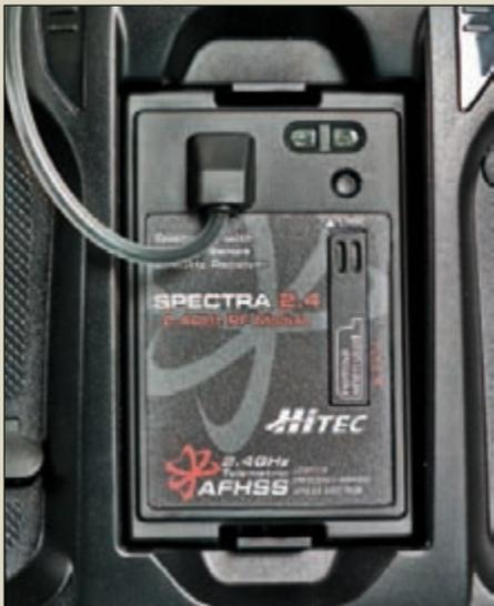
Das HF-Teil der Aurora nutzt den Modulsteckplatz auf der Senderrückseite. Das Spectra-Modul ist auch für die Optic 6 zu haben. Die 2,4-GHz-Antenne ersetzt die Teleskopantenne und wird über ein dünnes Zuleitungskabel direkt vom HF-Teil gespeist.
