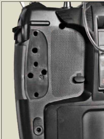
Die optionale Rastung bzw. Hemmung der beiden Kreuzknüppelaggregate können ohne Öffnen des Senders eingestellt werden. Dafür sind hinter der Gummiermierung und unter einer kleinen Gummiabdeckung Öffnungen vorhanden.
