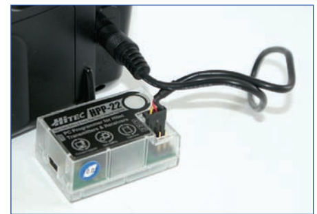
Mit dem HPP-22 können Modelldaten vom Sender zum PC übertragen oder auch die Software aktualisiert werden.
