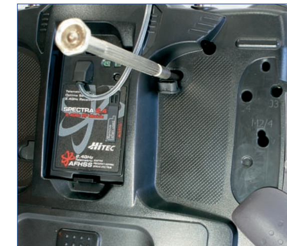
Sowohl Rastung und Hemmung des Gas-/Pitchknüppels als auch die Rückstellhärte sämtlicher Federn können mit einem kleinen Schraubendreher von der Rückseite verändert werden, ohne den Sender zu öffnen.
