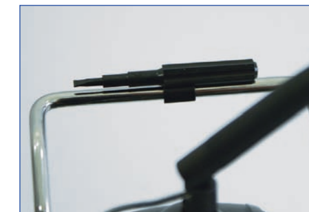
Ein Kunststoffstift vereinfacht die Bedienung. Bewährt hat sich ein Gyro-Schraubendreher, der am Tragebügel befestigt wird und so immer dabei ist.
