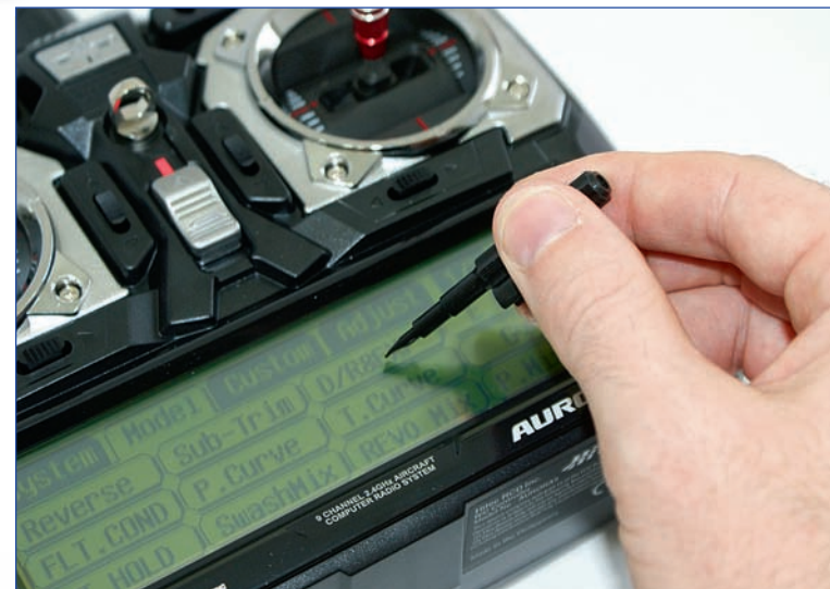
Ein Kunststoffstift vereinfacht die Bedienung. Bewährt hat sich ein Gyro-Schraubendreher, der am Tragebügel befestigt wird und so immer dabei ist.
