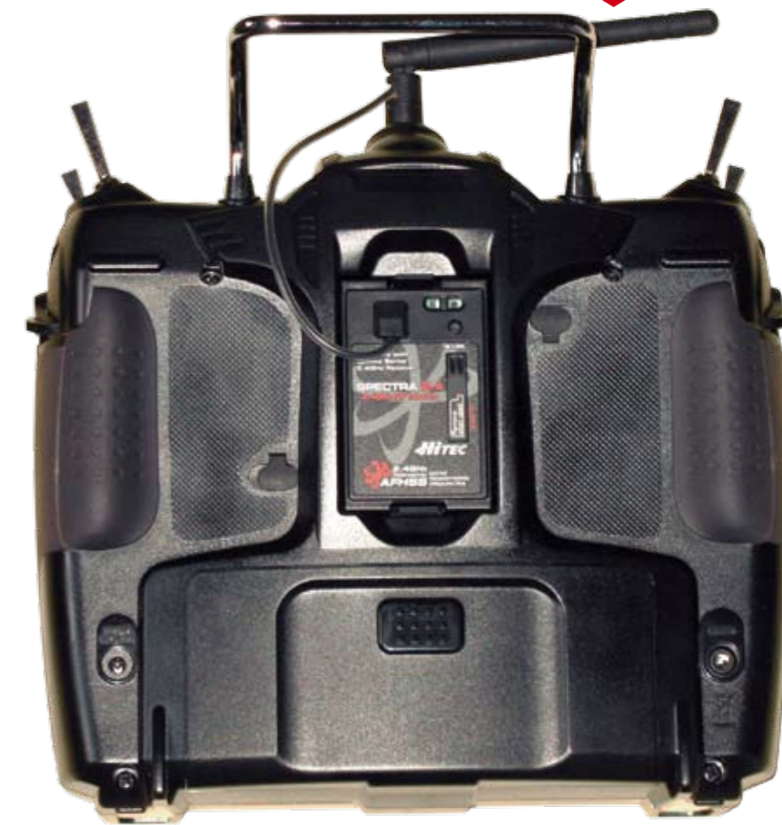
Blick auf die Rückfront der Aurora 9 mit ihren gummierten Seitenflanken. Das Zuführungskabel vom HF-Modul zur Antenne liegt frei. Ladebuchse und der Trainer/Simulator-Anschluss sind hier ebenfalls untergebracht
