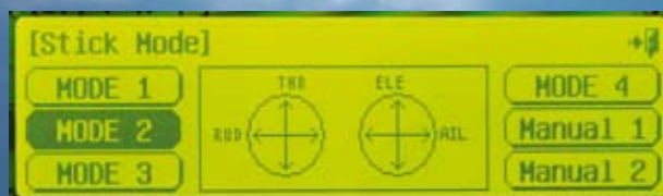
Im Stick-Mode wählt man den gewünschten Steuermodus (hier Mode 2). Nach einem Touch auf Manual 1 kann man jede der vier Stick-Funktion anklicken und mit einem weiteren Touch dem gewünschten Knüppel zuordnen
