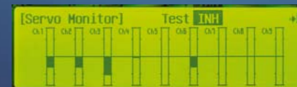
Im Servo Monitor lassen sich alle zugewiesenen Funktionen testen. Nach einem Touch auf INH startet das Servo-Testprogramm. Die Stellgeschwindigkeit aller Servos kann dabei mit dem Gasknüppel stufenlos beeinflusst werden
