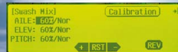
Unter Swash Mix erfolgt die Feinabstimmung der drei Taumelscheibenservos sowie deren Laufrichtung. Nach Anklicken von Calibration ...
