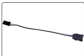
Bitte trennen Sie zuerst die mittlere rote Litze des Adapter-Kabels Best.-Nr. 7168.6A durch. Verbinden Sie das Kabel anschließend mit der USB Schnittstelle Best.-Nr. 7168.6. Das Stecksystem ist verpolungssicher, achten Sie auf die kleinen seitlichen Nasen. Wenden Sie auf keinen Fall Gewalt an, der Stecker sollte leicht einrasten.
