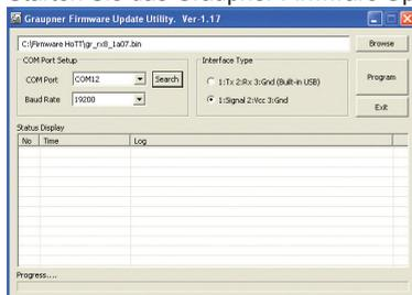
Wählen Sie unter [COM Port Setup] den korrekten COM-Port aus, an dem das USB-Kabel angeschlossen ist. Wenn Sie nicht sicher sind, drücken Sie den Button „Search“ und wählen im Popup-Fenster den Anschluss „Silicon Labs CP210x USB to UART Bridge“ und drücken „OK“. Baud Rate: 19200.
